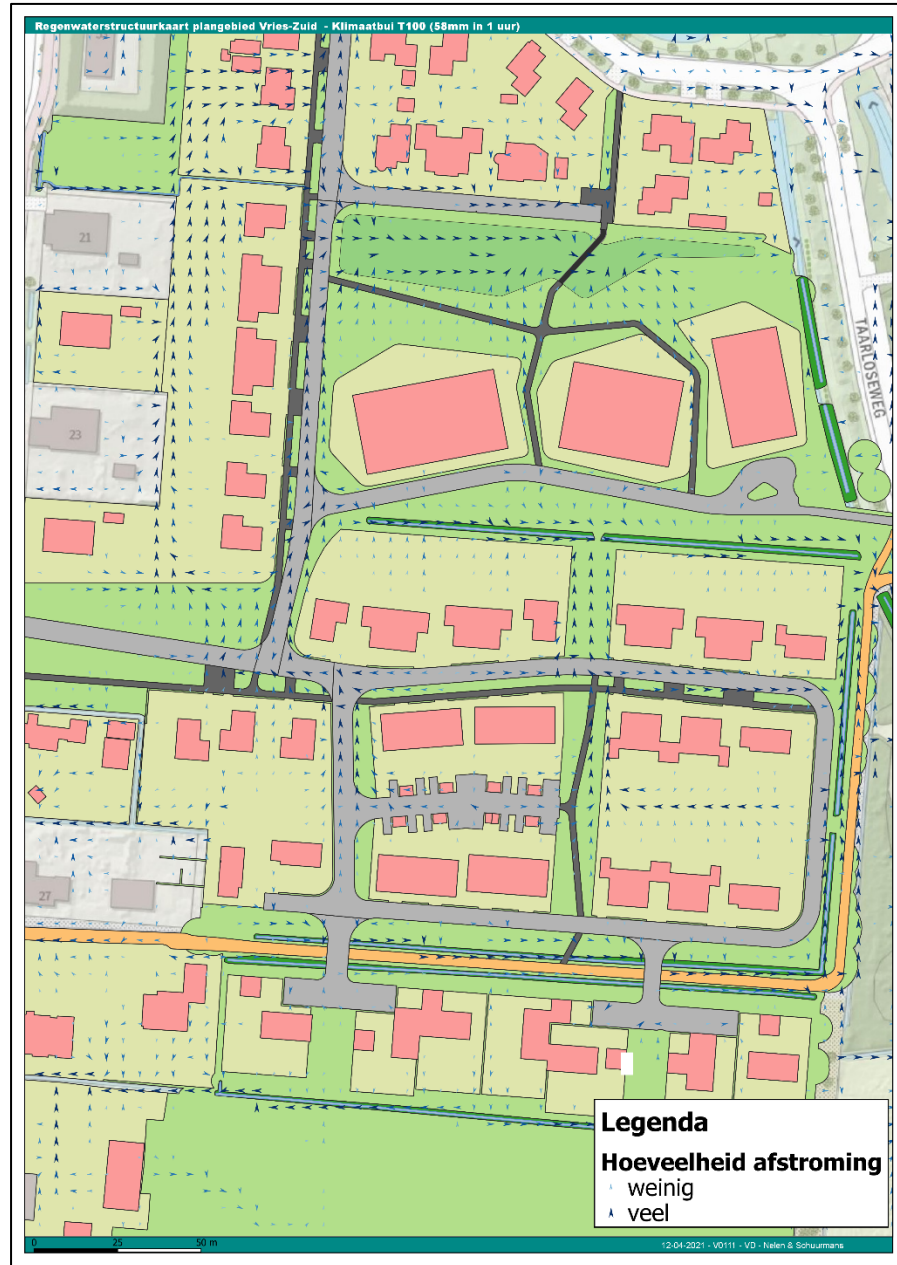
Figuur 4-5: Regenwaterstructuurkaart van de toekomstige situatie bij klimaatbui T100 (58mm in 1 uur) – ingezoomd op Vries Zuid.
