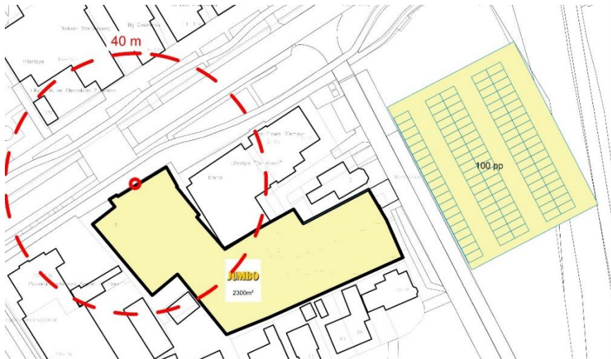
Tekening 2. De beschikbare ruimte op eigen terrein en het ruimtebeslag van 100 parkeerplaatsen.
