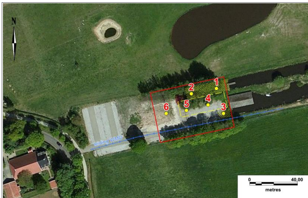
Figuur 11: Midlaren, Groningerstraat 21: boorpuntenkaart. Het onderzoeksgebied is rood omlijnd. De onderbroken gele lijn is de geplande locatie van het te bouwen woonhuis. Op de geel gearceerde delen zullen de sloten worden verlengd. De genummerde punten zijn van de zes boringen. Door het zuiden van het onderzoeksgebied loopt een waterleiding van de WMD.
