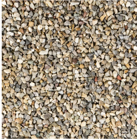
Ontsluitingsweg heeft een toplaag van moraine 2/6mm
