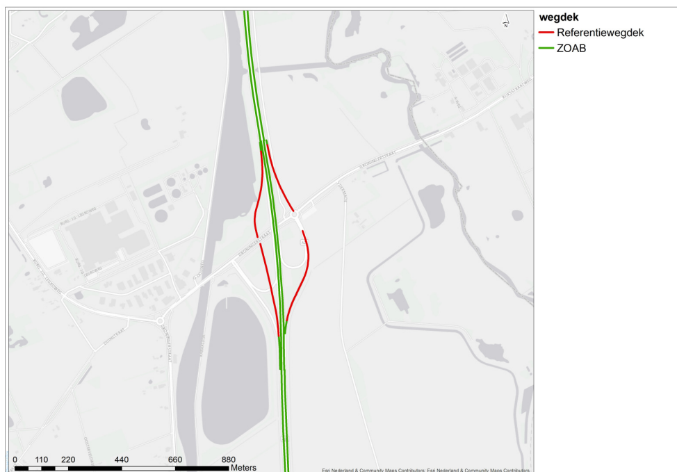
Afbeelding 4.2 . Globaal overzicht van de wegdekverhardingen conform registerdata
